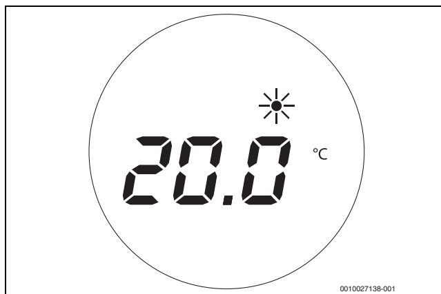
Fig. 2 Exemple en mode de fonctionnement chauffage
