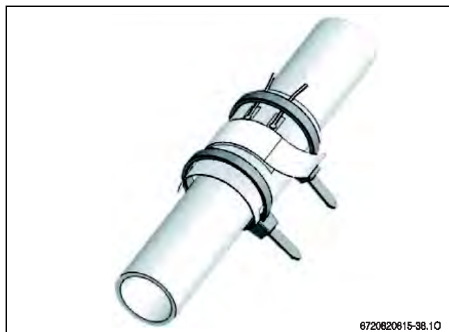
Bild 27 Montage des Taupunktfühlers (Beispiel)
